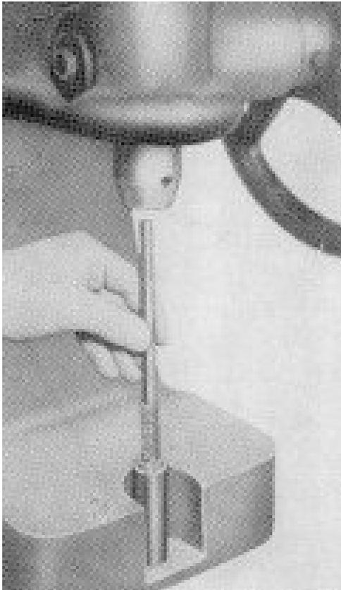
Kolbenstange mit Reibsegment in die Montagehülse EV 32350-7 einführen.
