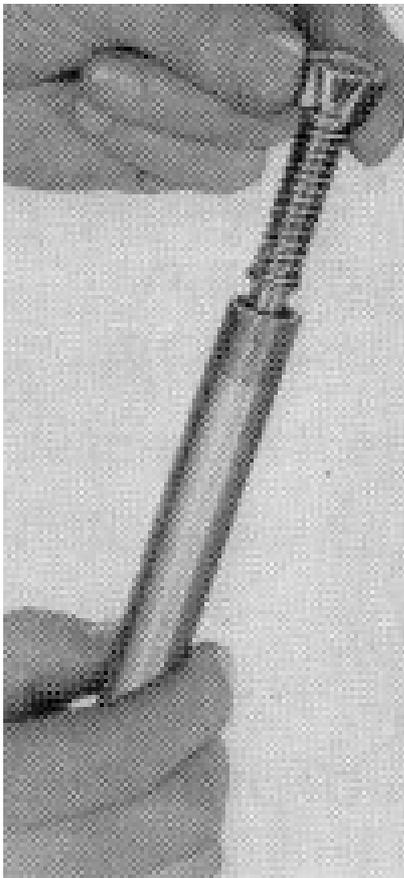
Oberes Einspannstück vom Gleitrohr schrauben und Kolbenstange mit Reibsegment herausstoßen.
