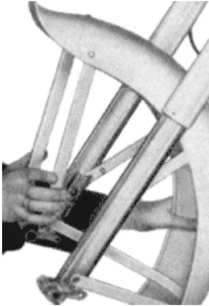
Bild 92. Vorderradschutzblech ausbauen
