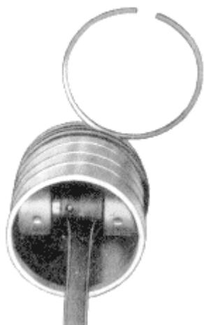
Bild 80. Kolbenringe müssen sich in den Nuten rundum klemmfrei abrollen lassen
