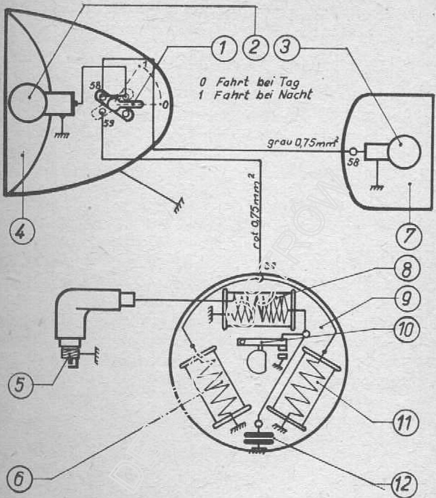
Bild 8. Elektrischer Schaltplan für *simson-mofa 1*
