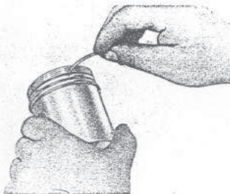
Rys. 40. Czyszczenie rowków pierścieni
