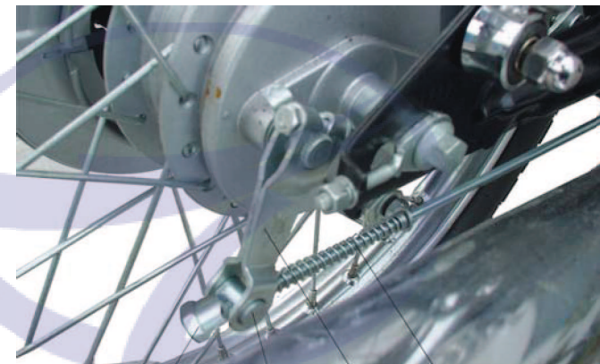
1.adjusting nut 2.brake arm pin 3.rear brake arm 4.brake pull rod
